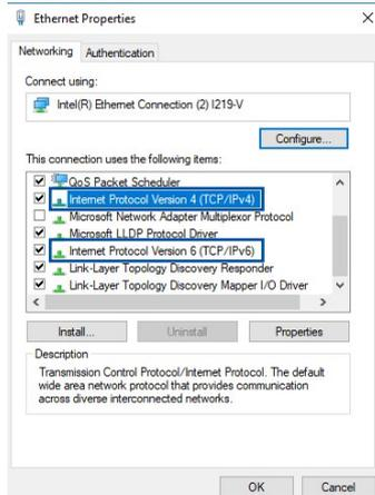
4. Um die IPv4-IP-Einstellungen automatisch zu beziehen, wählen Sie **Obtain an IP address automatically (IP-Adresse automatisch beziehen)**.
