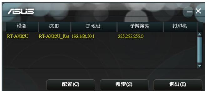
**HINWEIS:** Wenn Sie beim Router den Access Point (Zugangspunkt)-Modus einstellen, müssen Sie die Device Discovery (Geräteerkennung) verwenden, um die IP-Adresse des Routers zu erhalten.
