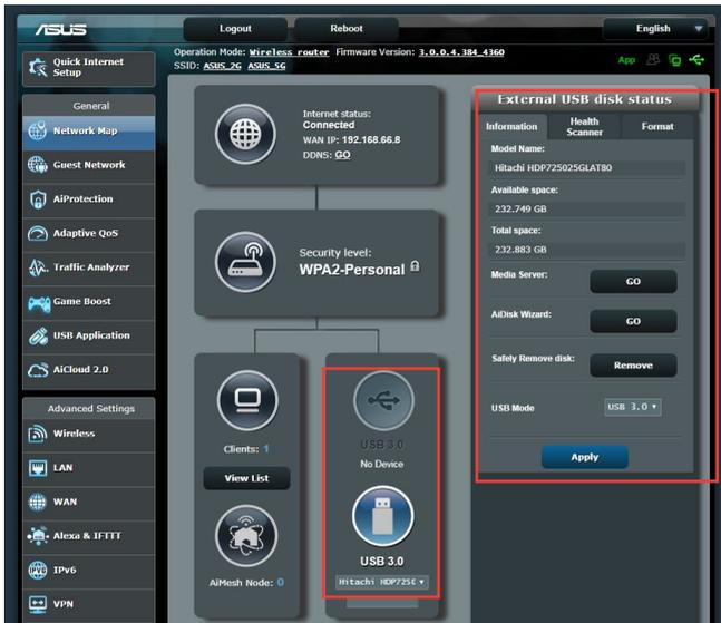
**HINWEIS:** Um diese Funktion zu verwenden, müssen Sie einen USB-Datenträger, wie eine USB-Festplatte oder ein USB-Flashlaufwerk, mit dem USB 3.0 Anschluss auf der Rückseite Ihres WLAN-Routers verbinden. Stellen Sie sicher, dass der USB-Datenträger richtig formatiert und partitioniert wurde. Für eine Liste unterstützter Dateisysteme für Ihre Laufwerke beziehen Sie sich auf die ASUS-Webseite unter <http://event.asus.com/networks/disksupport>.
