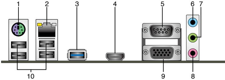
1. PS/2 鍵盤/滑鼠兩用連接埠：將 PS/2 鍵盤或滑鼠插頭連接到此連接埠。
