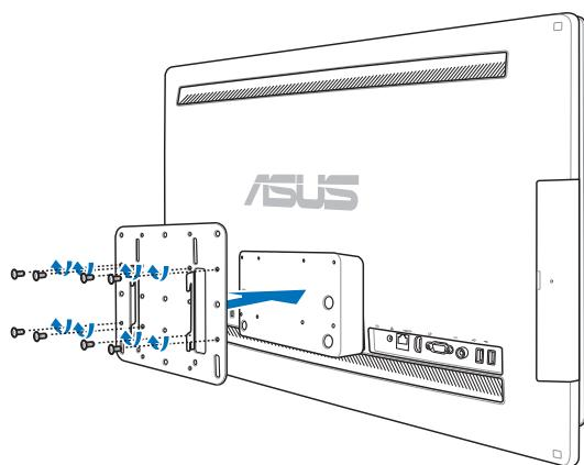
6. 按照您所使用的壁挂套件 (VESA100) 用户手册上的说明，使用套件内所附的 4 颗螺丝 (M4 x 10L) 将壁挂支撑架锁至墙面上。然后将 All-in-one PC 牢牢地挂入壁挂套件支撑架的凹槽上。
