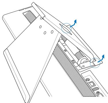
3. 接着卸除 4 颗固定立架的螺丝，并保留着以备往后需要装回时使用。然后将立架取出并放置于一旁。
