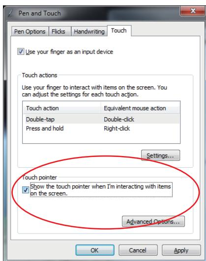
4. 当您触碰屏幕进行触摸操作时，您将会在屏幕上看到虚拟鼠标图标。
