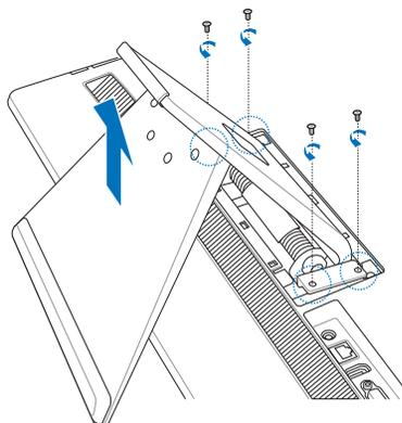
4. 将壁挂衬垫转接座上的四个孔位，对准 All-in-one PC 后方的安装孔装上。然后使用 4 颗螺丝（M4 × 7L）进行固定。
