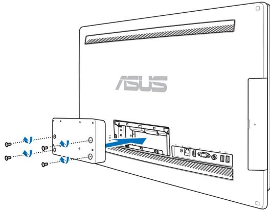
5. 再将壁挂衬垫上的孔位对准转接座锁上 8 颗螺丝（M3 × 8L）做固定。
